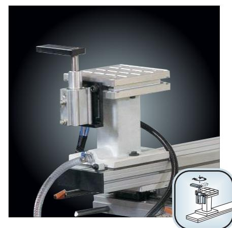
**IT** I pressori pneumatici TURN permettono, grazie allo stelo rotante, di "liberare" momentaneamente l'area di bloccaggio per permettere all'utensile di lavorare. Sono ideali per pezzi stretti che debbono essere necessariamente lavorati su tutto il perimetro in un'unica volta. Con i pressori TURN si evitano quindi riprese del pezzo. Possono essere comandati a gruppi oppure individualmente. La fase di rotazione per lo sbloccaggio e successivo ri-bloccaggio avviene con apposite funzioni M.
