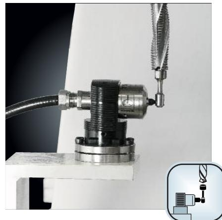
**IT** Sistema di tastatura che, abbinato al software specifico, permette: controllo automatico del posizionamento e ri-orientamento del pezzo; tastatura di punti per verifica e certificazione delle lavorazioni.
