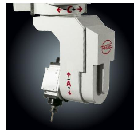
**IT** 1 motore bimandrino montato su un supporto monobraccio. Tipicamente usata in lavorazioni dove non sono necessari diversi utensili (massimo 2), ad esempio lavorazione di scocche in legno oppure fresatura di componenti plasticici dopo la pressatura.
